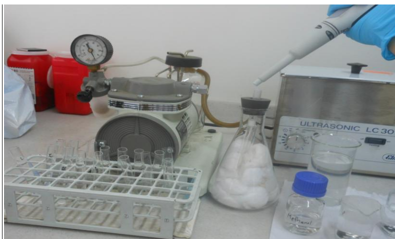
Figura 3 Extracción en fase sólida con sistema de vacío para la concentración de los analitos presentes en las muestras ambientales.
